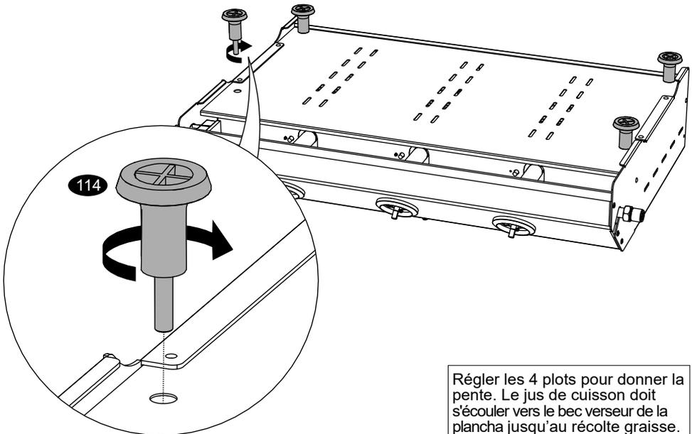
Régler les 4 plots pour donner la pente. Le jus de cuisson doit s'écouler vers le bec verseur de la plancha jusqu'au récolte graisse. Avant cuisson, vérifier l'écoulement avec un verre d'eau.
